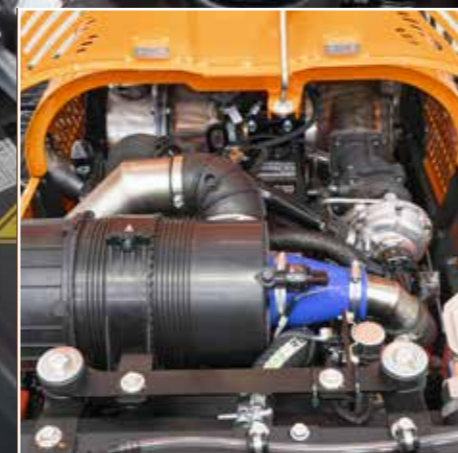
60-PS-MOTOR VON YANMAR, STUFE V
