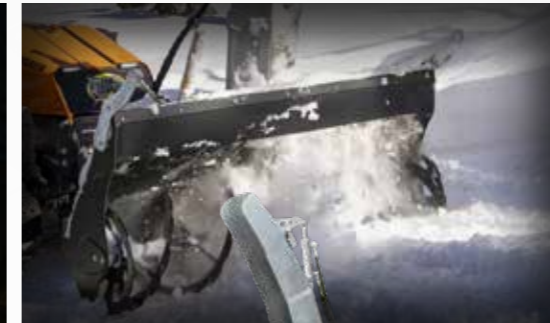
FORESTRY HEAD 150 FORSTMULCHER - ROTOR MIT FESTSTEHENDEN MESSERN
