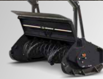
FORESTRY HEAD 150 FORSTMULCHER - ROTOR MIT FESTSTEHENDEN MESSERN
