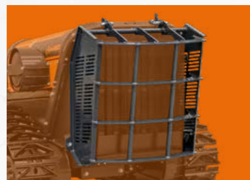
Klappbarer Kühlerschutz aus Stahl
