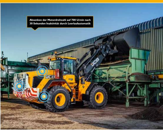
Die neue Funktion "Automatische Motorabschaltung" spart Kraftstoff, da sie den Motor abschaltet, wenn sich die Maschine länger im Leerlauf befindet. Die Leerlaufzeit kann der Bediener vom Kabinensitz aus einstellen.
